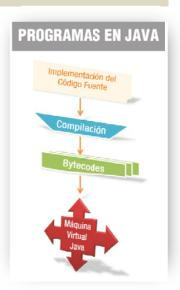
**Bytecode**: Son un conjunto de instrucciones en lenguaje máquina que no son específicas a ningún procesador o sistema de cómputo. Un intérprete de código de bytes (bytecodes) para una plataforma específica será quien los ejecute. A estos intérpretes también se les conoce como Máquinas Virtuales Java o intérpretes Java de tiempo de ejecución.
