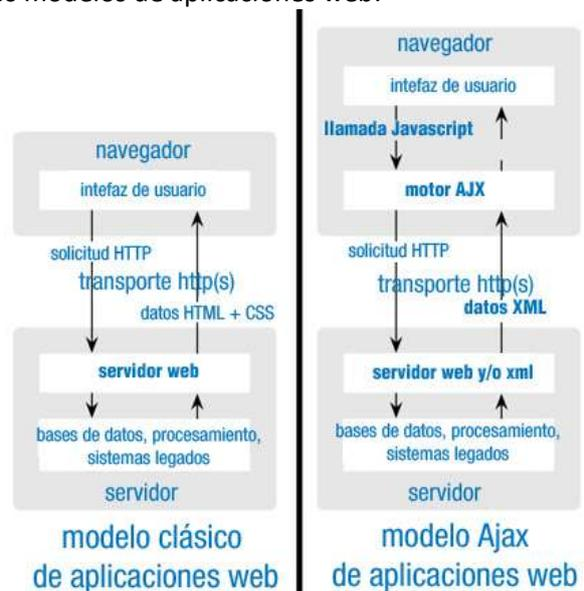
Cada acción del usuario, que normalmente generaría una petición HTTP al servidor, se va a convertir en una petición AJAX con esa solicitud, y será este motor, el que se encargará de todo el proceso de comunicación y obtención de datos de forma asíncrona con el servidor, y todo ello sin frenar la interacción del usuario con la aplicación.
